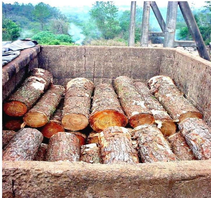
Foto N° 3: Detalle de la piletta cargada próxima a ser cubierta con el plástico negro para su posterior cocción. En el Anexo N° 26 se puede ver el detalle de cómo se realiza la carga y descarga de la piletta con el aparejo eléctrico-monorriel.
