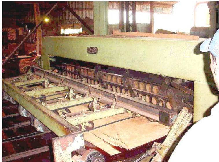
**Foto N° 4: Detalle de la guillotina en el momento del corte.**
