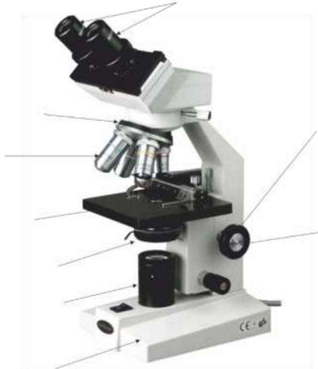
Fig. 2. Microscopio óptico. Partes: objetivos, revólver, platina, pie o base, diafragma, condensador, ocular, brazo, tornillo macro, tornillo micro, fuente de luz.
