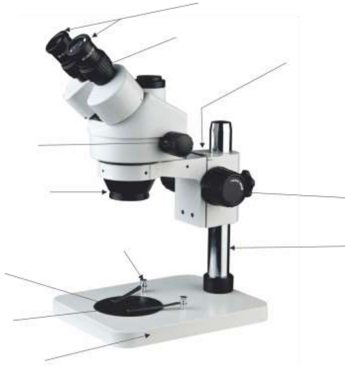
Fig. 1. Microscopio estereoscópico. Partes: oculares, ocular ajustable, brazo, objetivo, tornillo macrométrico, tornillo de sujeción, soporte, pinzas de platina, pie, platina, placa de contraste.
