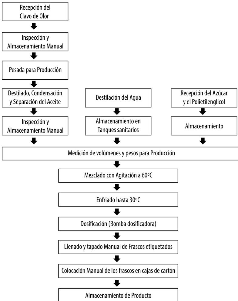
En este sistema, el proceso se realiza adiabáticamente, y el calor que entra con el vapor saturado a 100°C, se puede suponer que es el mismo que el que sale (se consideran las pérdidas despreciables). Por lo tanto la cantidad de calor suministrado para producir el vapor de agua necesario para la destilación es de 1540 Kcal/h.
