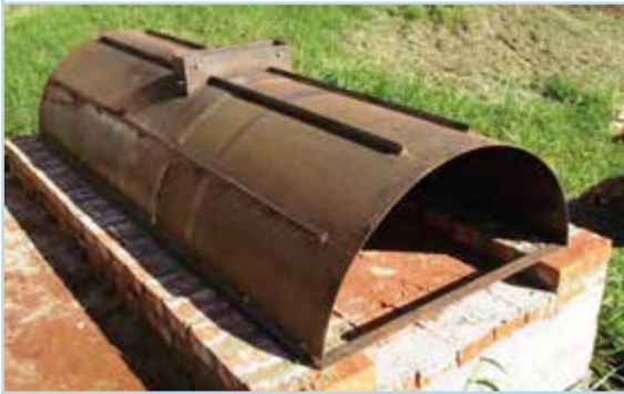
FIGURA 5 HORNO SEMICIRCULAR CON REFUERZOS.
