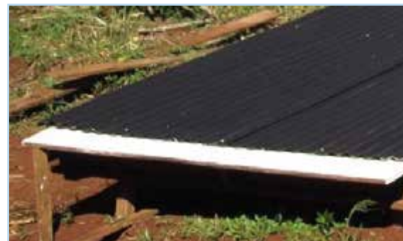
FIGURA 55 INGRESO DE AIRE EN LA PARTE INFERIOR DE LA PLACA.
