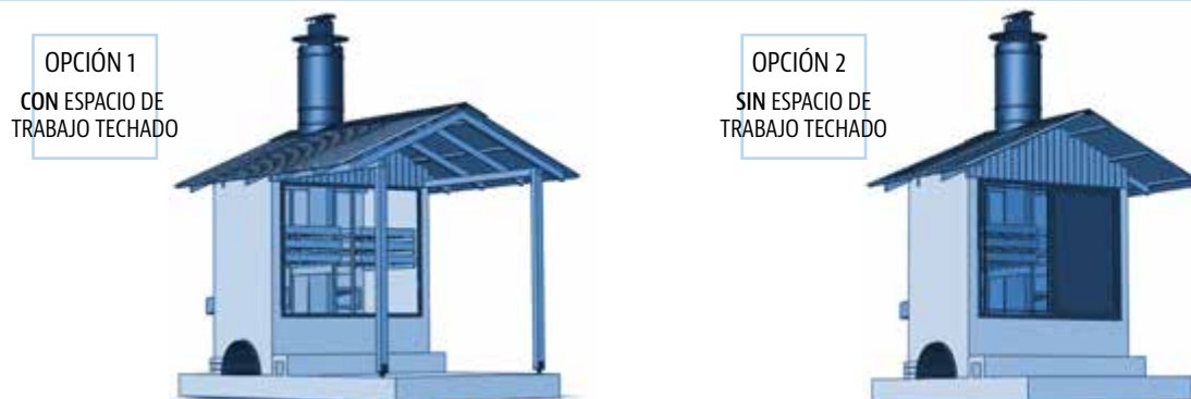
FIGURAS 20 / 21 MODELOS DE TECHO: DOS PROPUESTAS A ELECCIÓN. EN EL MODELO MULTIFAMILIAR, SE DUPLICA EL ESPACIO TECHADO.
