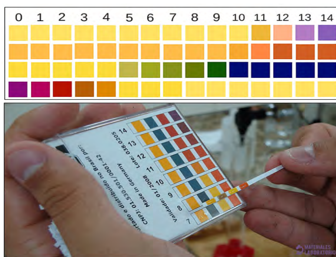
Figura 5. Escala de pH, patrón de colores de las cintas indicadoras y determinación del pH por comparación con la escala.
