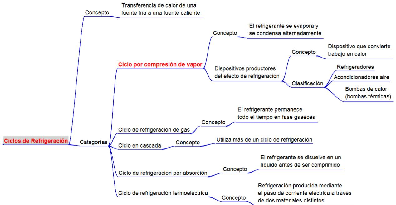
**Figura 47.** Categorías de ciclos de refrigeración (Fuente: Cátedra de Termodinámica, 2018).
